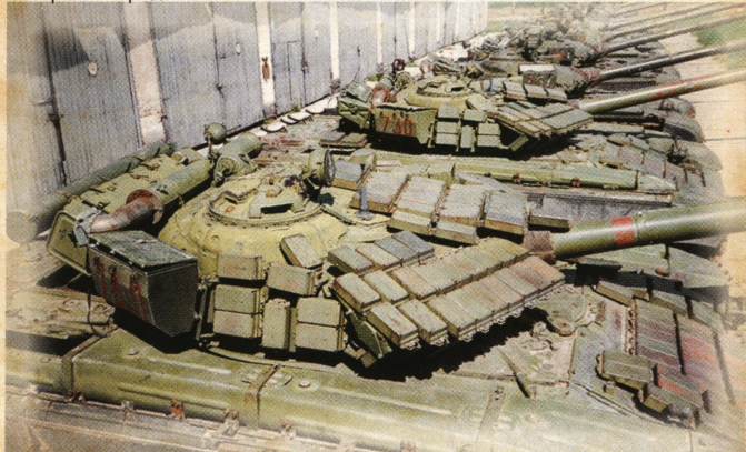
Танки Т-64БВ в парке, вид сверху. Хорошо видно размещение блоков динамической защиты.
