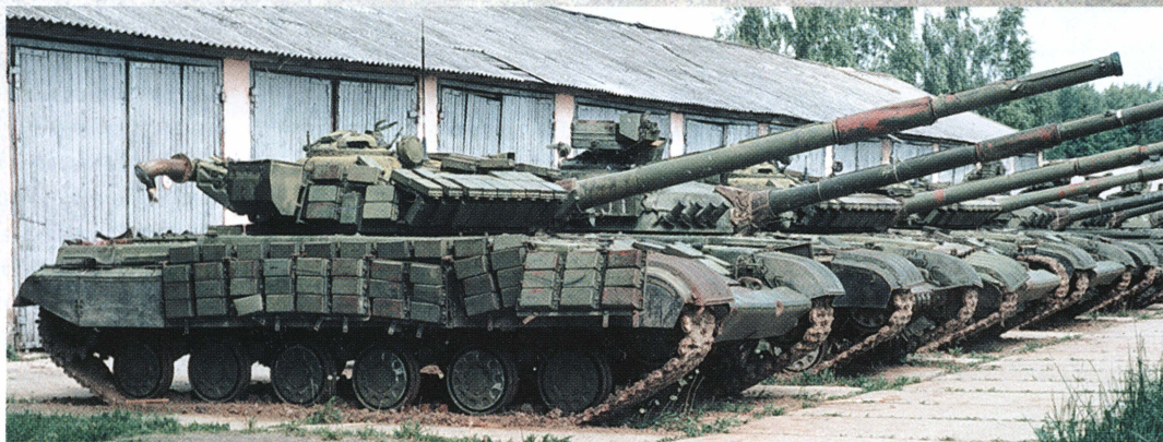
Командирский танк Т-64Б1ВК с навесной динамической защитой «Контакт-1».
