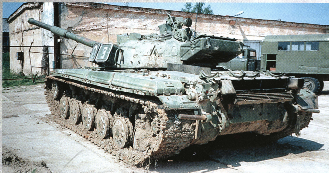
Танк Т-64Б, вид сзади. На Т-64Б стали устанавливать специальные отбойники (металлические штыри над гусеницей сзади) для предотвращения затаскивания посторонних предметов на верхнюю ветвь гусеницы.
