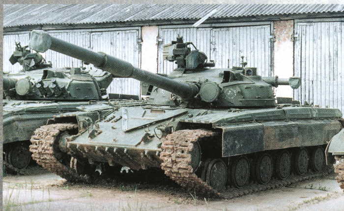
Танк Т-64А выпуска 1973 года. Машина прошла капитальный ремонт, и имеет дополнительный 30-мм лист брони на лобовом листе корпуса и сплошной резиноканевый бортовой экран.
